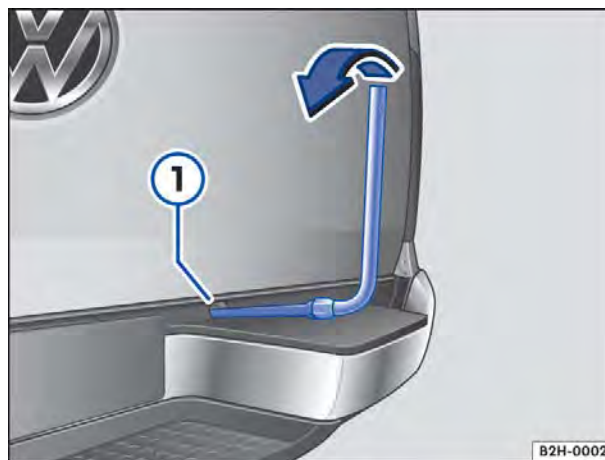
Fig. 152 Girar a roda sobressalente para baixo pelo guincho.
