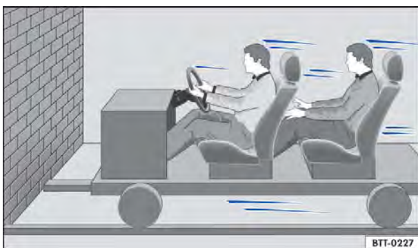
Fig. 46 Um veículo com os ocupantes do veículo sem cintos de segurança está em rota de colisão com um muro.
