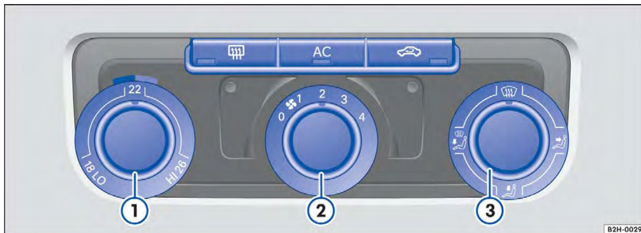
Fig. 121 No painel de instrumentos: comandos do Climatic.
