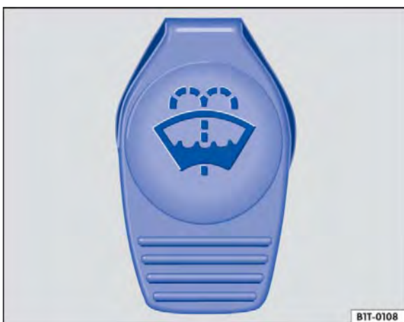
Fig. 78 No compartimento do motor: tampa do reservatório de água dos lavadores do para-brisa.
