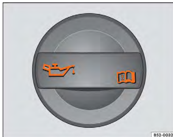
Fig. 134 No compartimento do motor: tampa da abertura para enchimento de óleo do motor.
