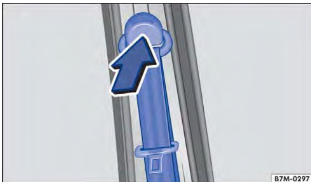
Fig. 59 Ao lado dos bancos dianteiros: regulagem de altura do cinto de segurança.
