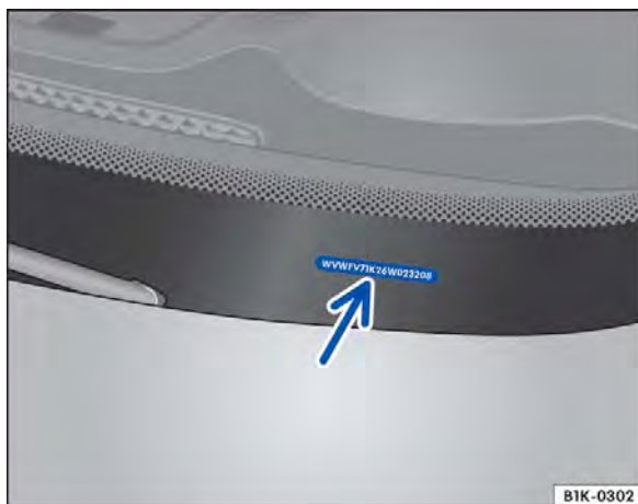
Fig. 17 Na área esquerda do para-brisa: número de identificação do veículo.
