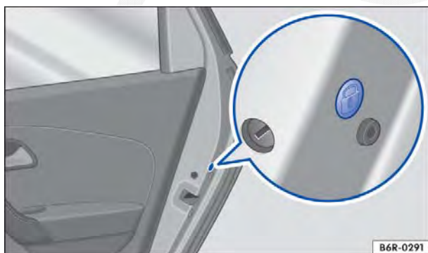
Fig. 146 Na parte dianteira da porta traseira direita: travamento de emergência, coberto por uma vedação de borracha.
