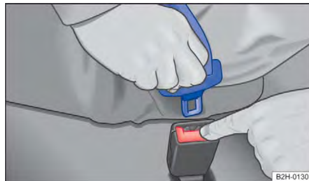
Fig. 56 Soltar a lingueta do cinto de segurança subabdominal do fecho do cinto de segurança
