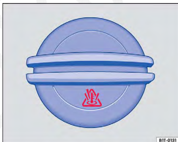
Fig. 138 No compartimento do motor: tampa do reservatório de expansão do líquido de arrefecimento do motor.
