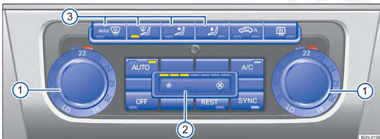
Fig. 122 No painel de instrumentos: comandos do Climatronic.
