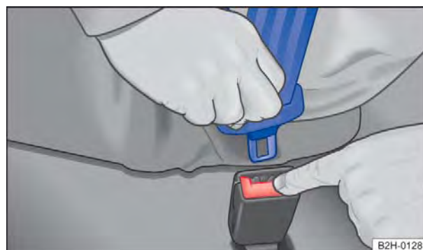
Fig. 54 Soltar a lingueta do cinto de segurança do fecho do cinto de segurança.
