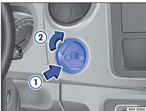
Fig. 90 Posicionar o acessório no ponto de multifixação.
