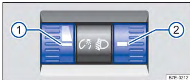
Fig. 73 Ao lado do volante: regulador da iluminação dos instrumentos e interruptores ① assim como regulagem de alcance do farol ②.
