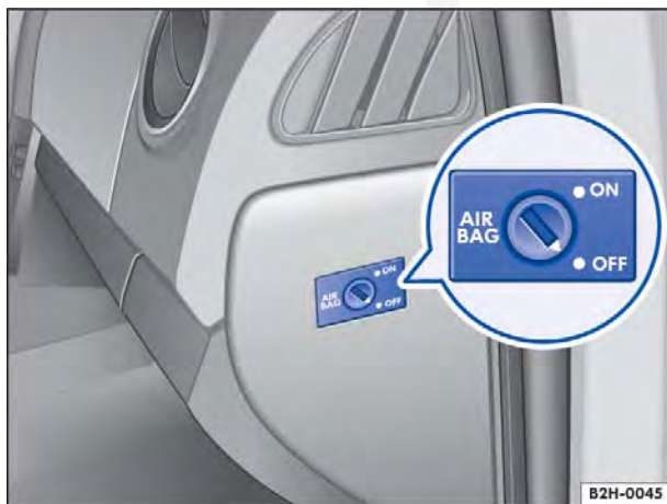
Fig. 63 Na parte frontal no lado do passageiro dianteiro: interruptor acionado pela chave para desativar e ativar o airbag frontal do passageiro dianteiro.
