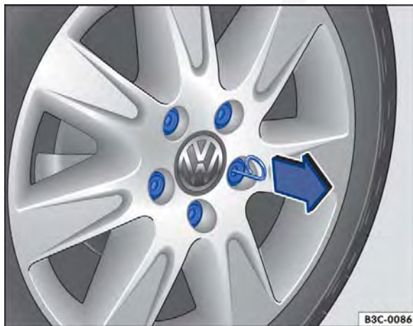
Fig. 150 Remover as capas de cobertura dos parafusos de roda.
