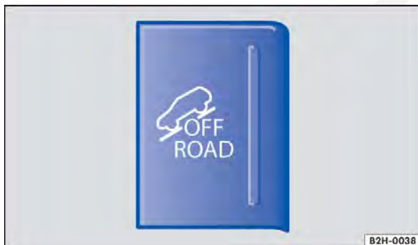
Fig. 110 No console central: botão para ligar e desligar a função off-road manualmente.
