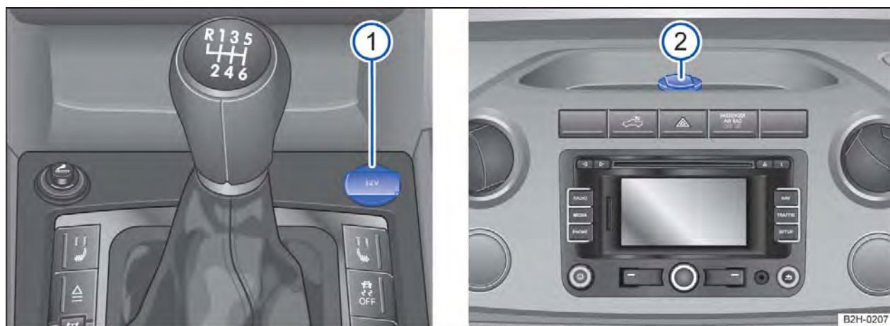
Fig. 96 Direção à esquerda: no console central dianteiro ① (em veículos com direção à direita é espelhado) e no porta-objetos no painel de instrumentos ②: tomada 12 V.
