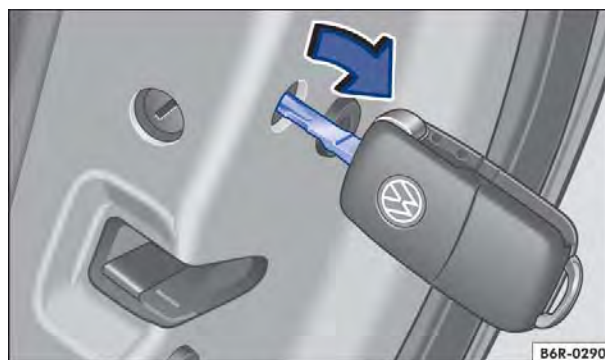
Fig. 147 Travamento de emergência do veículo com a chave do veículo.
