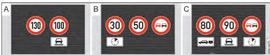
**Fig. 179** No display do instrumento combinado: exemplos de limites de velocidade e proibição de ultrapassagem com placas adicionais associadas.
