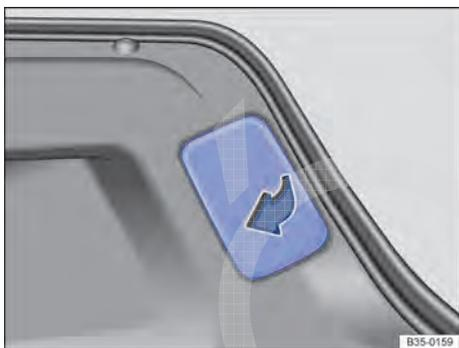
**Fig. 246** Na tampa do compartimento de bagagem: retirar a cobertura.
