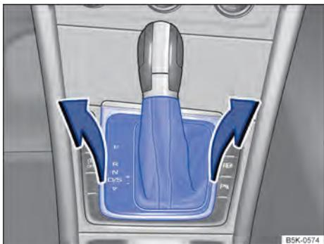
Fig. 220 Desinstalar a cobertura do quadro da alavanca seletora.
