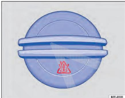
Fig. 199 No compartimento do motor: tampa do reservatório do líquido de arrefecimento do motor.
