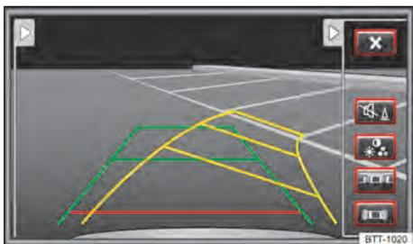
**Fig. 158** Exibição do display do rádio ou do sistema de navegação: câmera de marcha à ré, modo 1 ligado.
