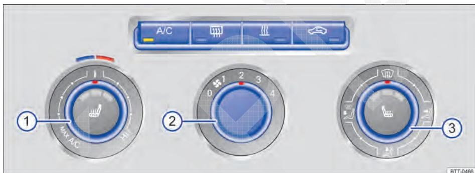
Fig. 183 No console central: comandos do ar-condicionado (manual).
