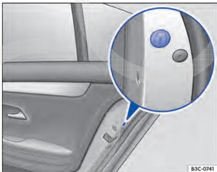
**Fig. 214** Na parte dianteira da porta traseira direita: travamento de emergência, coberto por uma vedação de borracha.
