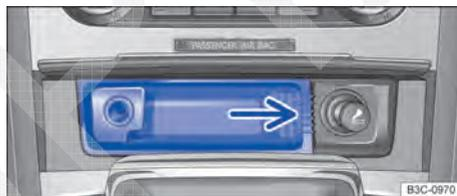
Fig. 129 No console central dianteiro: remover o cinzeiro.
