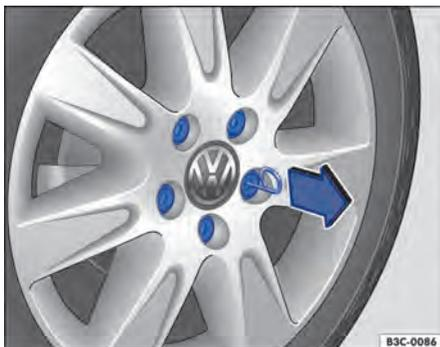
**Fig. 227** Remover as capas de cobertura dos parafusos de roda.
