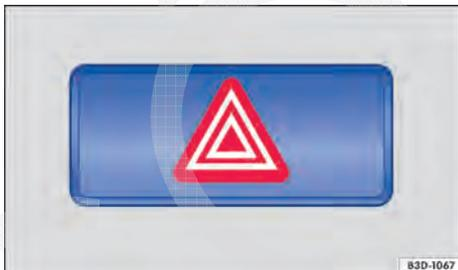
**Fig. 211** Na parte superior do console central: interruptor das luzes de advertência.
