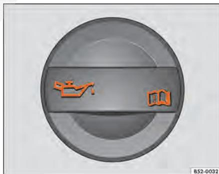
**Fig. 196** No compartimento do motor: tampa da abertura de enchimento de óleo do motor.
