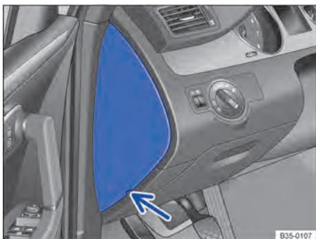
**Fig. 236** No lado do condutor do painel de instrumentos: cobertura da caixa de fusíveis.
