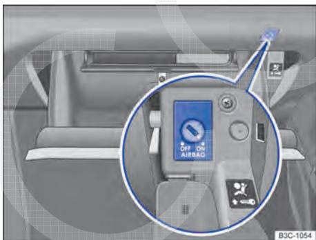
Fig. 75 No porta-luvas: interruptor acionado pela chave para desligar e ligar o airbag frontal do passageiro.
