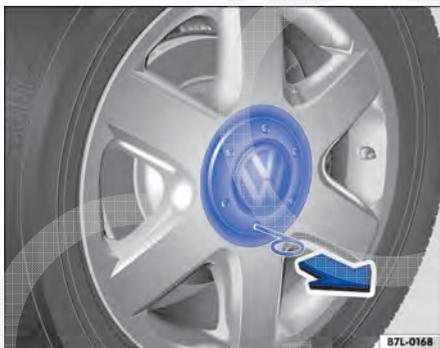
Fig. 224 Retirar a calota central.
