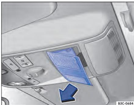
**Fig. 218** No revestimento do teto: remover a cobertura.
