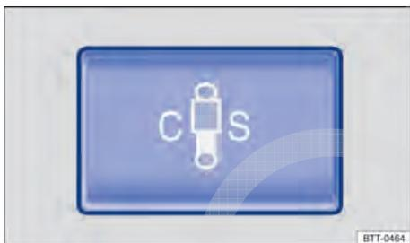
**Fig. 181** No console central: botão de ajuste da regulagem dinâmica da suspensão.
