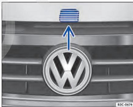
**Fig. 194** Em cima da grade do radiador: alavanca de destravamento para abrir a tampa do compartimento do motor.
