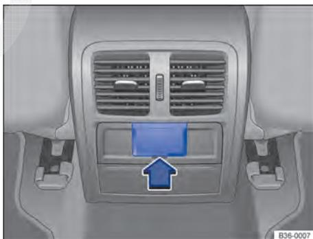
Fig. 135 Console central traseiro: abrir a cobertura dobrável.
