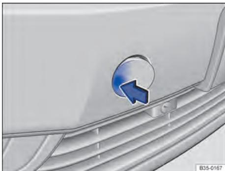
**Fig. 255** No para-choque dianteiro à direita: retirar a cobertura.
