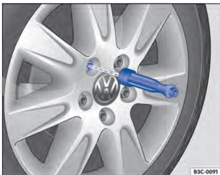
Fig. 234 Troca de roda: desparafusar os parafusos de roda com o punho da chave de fenda.
