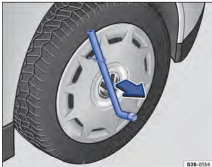
Fig. 226 Retirar a calota integral.
