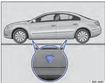
Fig. 230 Pontos de apoio do macaco.
