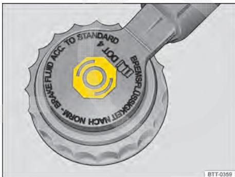
**Fig. 149** No compartimento do motor: tampa do reservatório do fluido de freio.
