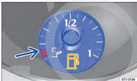
Fig. 188 No instrumento combinado: indicador do nível de combustível para gasolina e óleo diesel.
