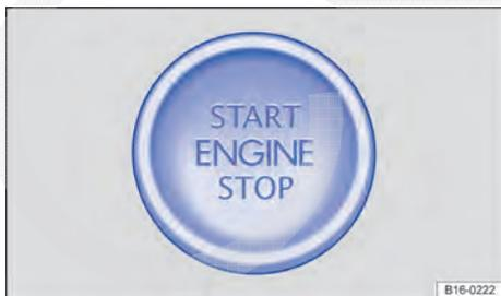
**Fig. 137** Na parte inferior do console central: botão de partida do sistema de fechamento e partida sem chave Keyless Access.
