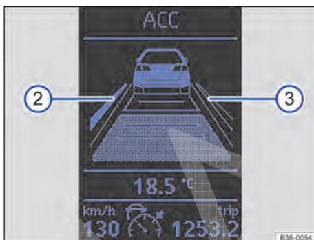
**Fig. 176** No display do instrumento combinado: indicador do display do assistente de permanência na faixa (exemplo 2).
