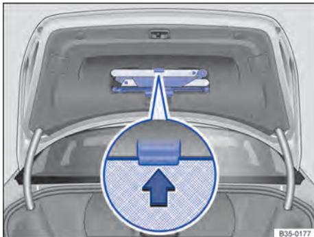
**Fig. 212** Na tampa do compartimento de bagagem: suporte para o triângulo de segurança.
