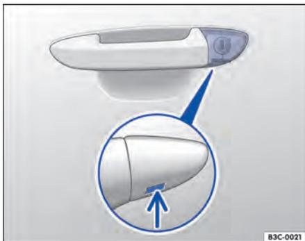
**Fig. 213** Maçaneta da porta do condutor: cilindro da fechadura coberto.
