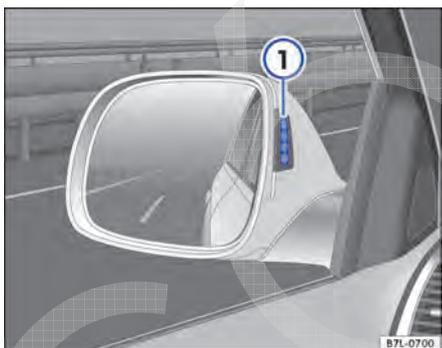
Fig. 178 No espelho retrovisor externo: indicador do assistente de mudança de faixa.
