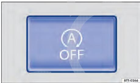
Fig. 152 No console central: botão do sistema Start-Stop.
