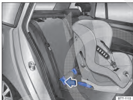
Fig. 7 Representação esquemática: instalar a cadeira de criança ISOFIX com os braços de apoio.
