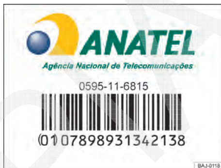
Fig. 18 Etiqueta com sequência numérica de homologação da ANATEL para o rádio RNS 315 com conexão Bluetooth.
