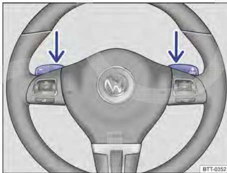
Fig. 121 Volante com 2 seletores basculantes do Tiptronic.
