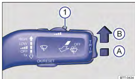
Fig. 94 Na alavanca dos limpadores do para-brisa à direita da coluna de direção: ajustar o sensor de chuva e de luz ①.
