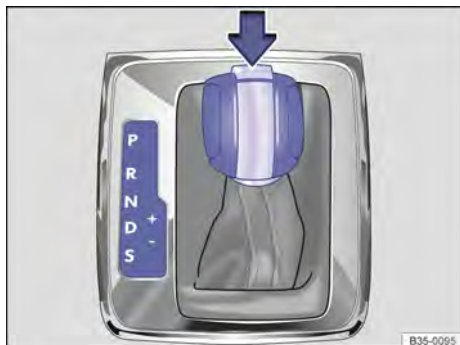
Fig. 118 Veículos com direção à esquerda: alavanca seletora da transmissão automática com botão bloqueador (seta).
