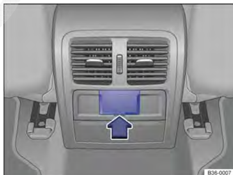
Fig. 180 Console central traseiro: abrir a cobertura dobrável.
