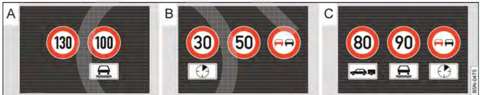
Fig. 42 No display do instrumento combinado: exemplos de limites de velocidade e proibição de ultrapassagem com placas adicionais associadas.
