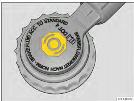
Fig. 232 No compartimento do motor: tampa do reservatório do fluido de freio.
