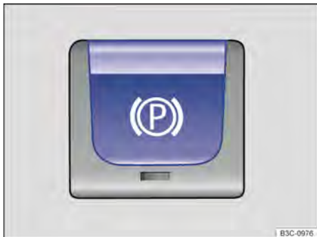
Fig. 140 Na parte inferior do console central: botão do freio de estacionamento eletrônico.
