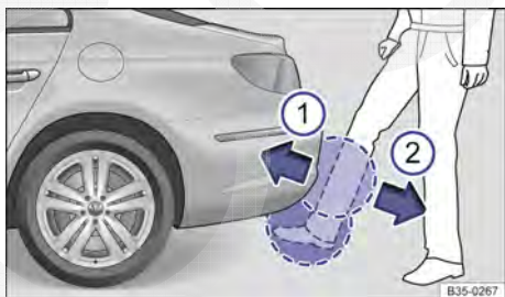
Fig. 64 Tampa do compartimento de bagagem com abertura controlada por sensor (Easy Open).
