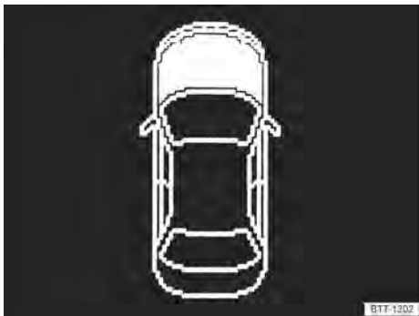
Fig. 226 Representação esquemática do display do instrumento combinado: tampa do compartimento do motor aberta ou fechada incorretamente.
