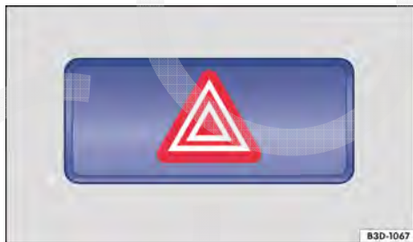
Fig. 27 Na parte superior do console central: interruptor das luzes de advertência.
