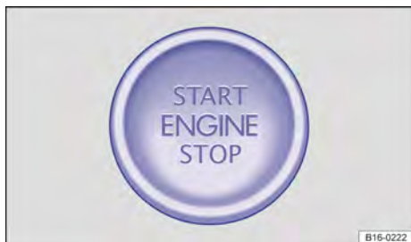
Fig. 113 Na parte inferior do console central: botão de partida para ligar o motor.
