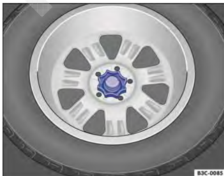
Fig. 240 No compartimento de bagagem: manípulo para fixação da roda sobressalente.
