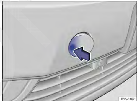
Fig. 222 No para-choque dianteiro à direita: remover a cobertura. ▶
