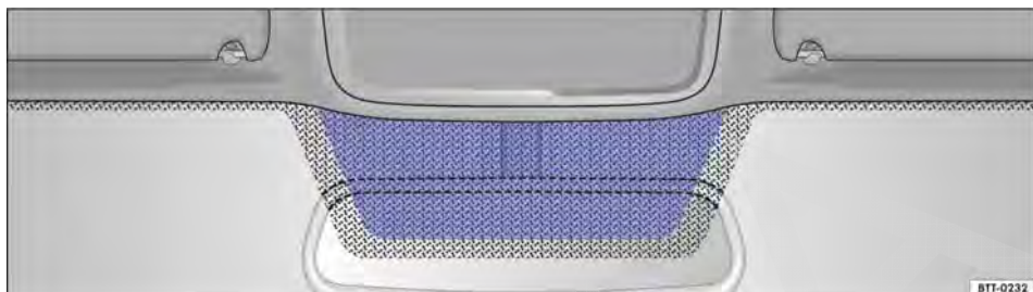
Fig. 102 Para-brisa de vidro de isolamento térmico: janela de comunicação acima do espelho retrovisor interno.
