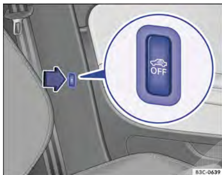
Fig. 57 Ao lado do banco do condutor: botão para desligar o monitoramento do interior do veículo e o alarme antirrebocagem.
