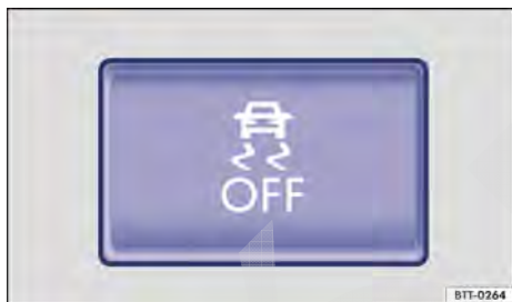
Fig. 158 No console central: botão para desligar e ligar o ASR manualmente.
