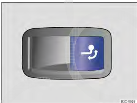
Fig. 194 No compartimento de bagagem, à direita: botão para destravamento da rótula de engate.
