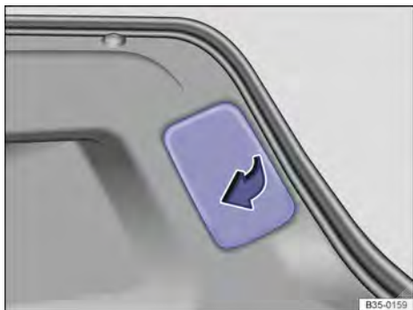
Fig. 208 Na tampa do compartimento de bagagem: remover a cobertura.
