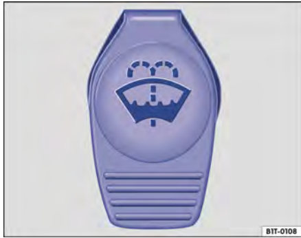
Fig. 227 No compartimento do motor: tampa do reservatório de água dos lavadores do para-brisa.
