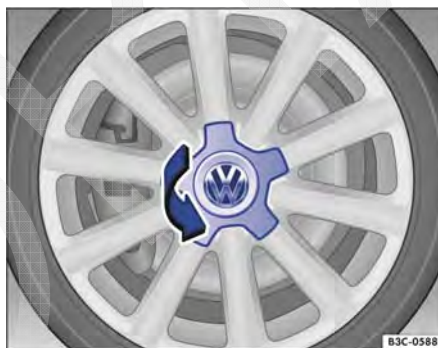
Fig. 243 Virar a calota central.
