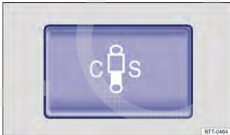
Fig. 124 No console central: botão de ajuste da regulagem dinâmica da suspensão.
