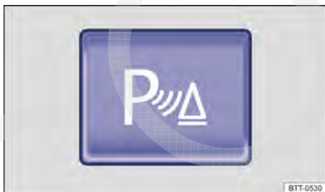
Fig. 142 No console central: botões para ligar e desligar o Park Pilot (dependendo da versão).
