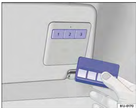
Fig. 72 Controle remoto e botões do comando de abertura de portão de garagem no para-sol.
