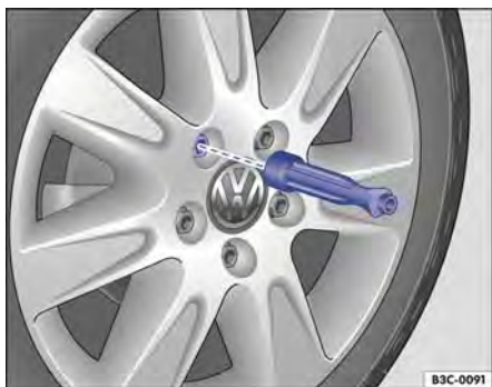
Fig. 252 Troca de roda: desaparafusar os parafusos de roda com o punho da chave de fenda.
