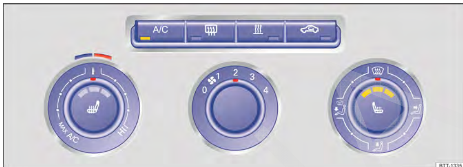
Fig. 103 Na parte superior do console central: comandos do ar-condicionado manual.
