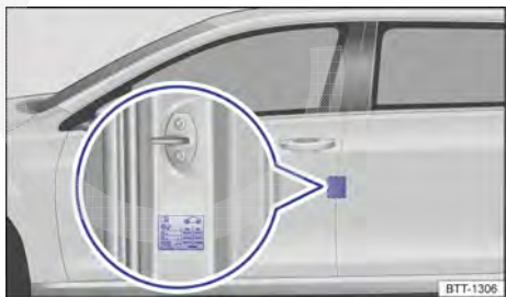
Fig. 238 Na coluna do condutor: etiqueta com as pressões dos pneus (alternativa ao lado interno da portinhola do tanque).
