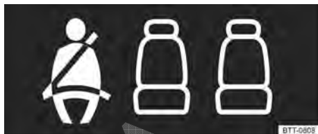
Fig. 3 Indicador de status do cinto de segurança no display do instrumento combinado para os assentos traseiros.
