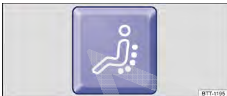
Fig. 89 Na região inferior do banco do condutor: botão da função de massagem.
