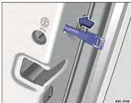
Fig. 62 Na parte dianteira da porta traseira direita: travamento de emergência do veículo com a chave de emergência.
