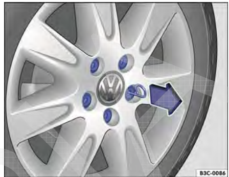
Fig. 245 Remover as capas de cobertura dos parafusos de roda.
