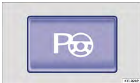
Fig. 154 Na parte inferior do console central: botão para ligar o assistente de direção para estacionamento.
