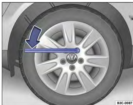
Fig. 246 Troca de roda: afrouxar os parafusos de roda.
