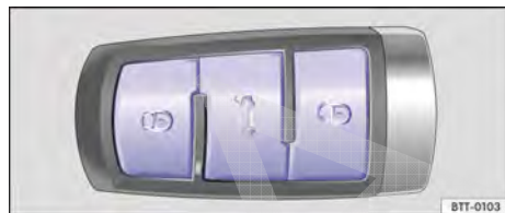
Fig. 52 Chave do veículo: travamento central.
