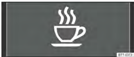
Fig. 41 No display do instrumento combinado: símbolo do sistema de reconhecimento de cansaço.
