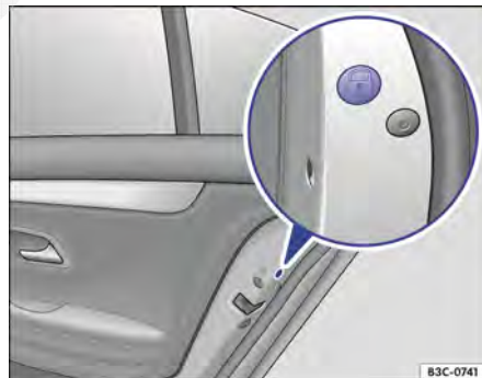
Fig. 61 Na parte dianteira da porta traseira direita: travamento de emergência, coberto por uma vedação de borracha.
