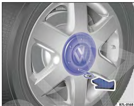
Fig. 242 Retirar a calota central.
