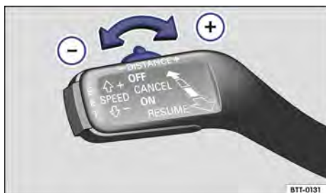
Fig. 130 Alavanca de comando ACC à esquerda na coluna de direção: ajustar o nível de distância.
