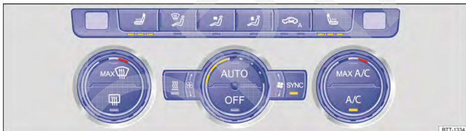
Fig. 104 Na parte superior do console central: comandos do Climatronic.
