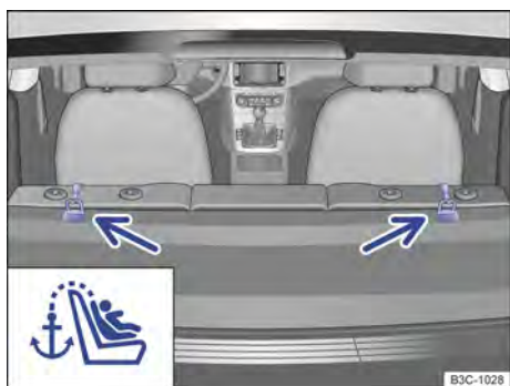
Fig. 26 Olhais de retenção para o cinto de fixação superior no lado de trás do banco traseiro.
