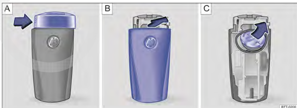
Fig. 50 Chave do veículo: substituir a pilha botão. ▶
