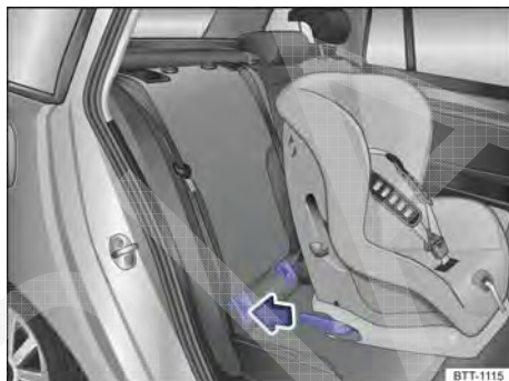
Fig. 25 Representação esquemática: instalar a cadeira de criança ISOFIX com os braços de apoio.
