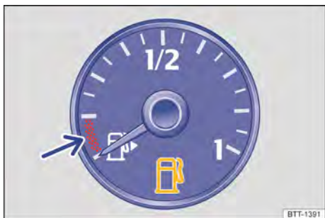
Fig. 43 No instrumento combinado: indicador do nível de combustível para gasolina e óleo diesel.
