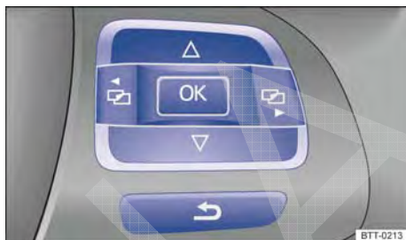
Fig. 47 No lado direito do volante multifunções: botões para comandar os menus do instrumento combinado.
