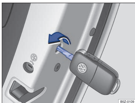
Fig. 53 Travamento de emergência do veículo com a chave do veículo.
