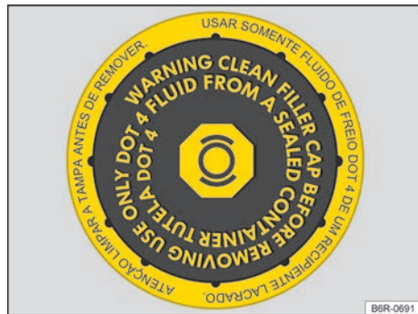
Fig. 182 No compartimento do motor: tampa do reservatório de fluido de freio (variante 1).
