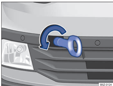
Fig. 172 No para-choque dianteiro à direita: rosquear a argola de reboque.
