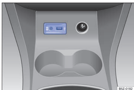
Fig. 101 No console central dianteiro: interface USB e entrada AUX-IN.
