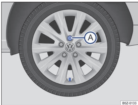
Fig. 193 Retirar a calota integral.
