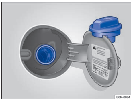
Fig. 144 Portinhola do tanque de combustível aberta com a tampa do tanque de combustível pendurada.
