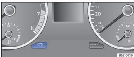
Fig. 71 No instrumento combinado: botão de regulagem da iluminação dos instrumentos e dos interruptores.
