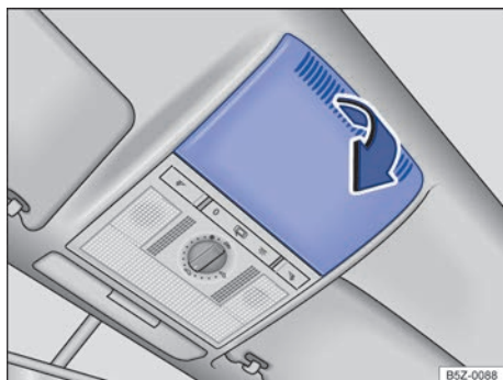
Fig. 58 No revestimento do teto: remover a cobertura.
