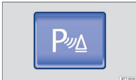
Fig. 92 Na parte superior do console central: botão para ligar e desligar o controle de distância de estacionamento (Park Pilot).
