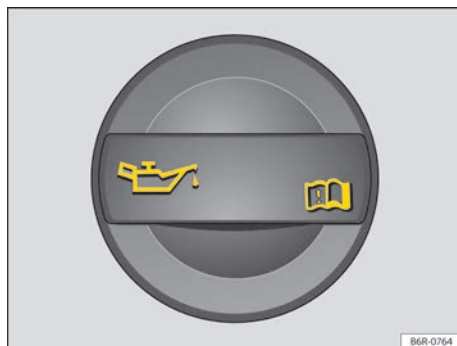
Fig. 179 No compartimento do motor: tampa da abertura para enchimento de óleo do motor.
