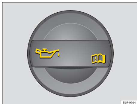
Fig. 152 No compartimento do motor: tampa da abertura para enchimento de óleo do motor.
