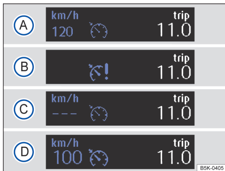
Fig. 102 No display do instrumento combinado: indicadores de status do GRA (representação esquemática).
