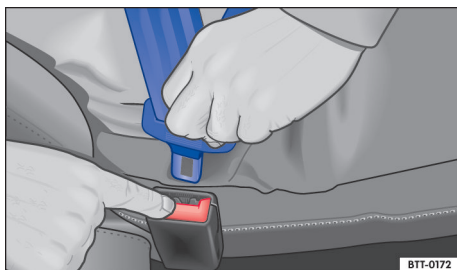
Fig. 32 Soltar a lingueta do cinto de segurança do fecho do cinto de segurança.
