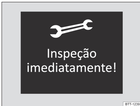
Fig. 19 No display do instrumento combinado: exemplo de indicação para um evento de serviço próximo de vencer (representação esquemática).
