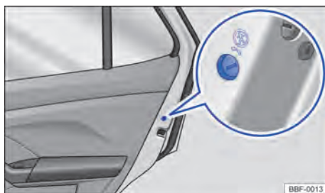
Fig. 47 Na porta traseira (lado direito): localização da trava de segurança para crianças.
