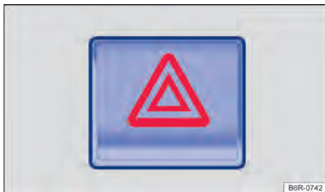
Fig. 48 Na parte superior do console central: interruptor das luzes de advertência.
