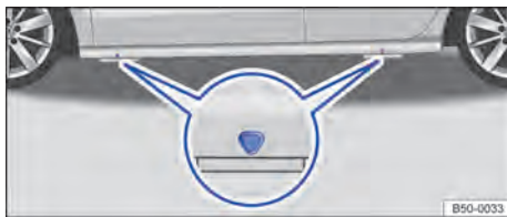
Fig. 221 Pontos de apoio do macaco.
