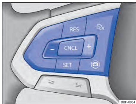
Fig. 106 Lado esquerdo do volante multifunções (variante 2): botões para comandar o limitador de velocidade.
