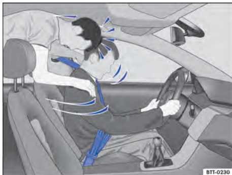
Fig. 28 O passageiro sem cinto de segurança no banco traseiro é lançado para frente sobre o condutor com cinto de segurança.
