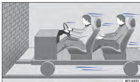
Fig. 25 Um veículo com os ocupantes sem cintos de segurança está em rota de colisão com um muro.
