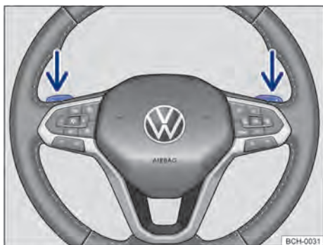
Fig. 98 Volante com seletores basculantes do Tiptronic.
