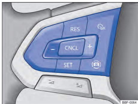
Fig. 104 Lado esquerdo do volante multifunções (variante 2): botões para comandar o GRA.
