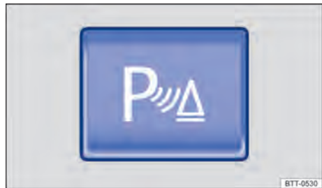
Fig. 113 No console central: botão para ligar e desligar o auxílio de estacionamento.
