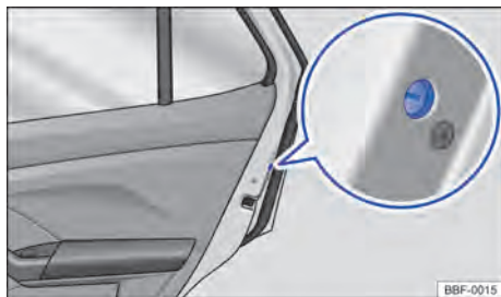
Fig. 58 Na porta traseira: travamento de emergência.
