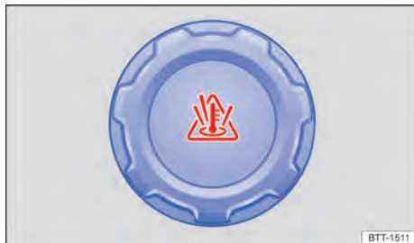
Fig. 209 No compartimento do motor: tampa do reservatório de expansão do líquido de arrefecimento do motor.
