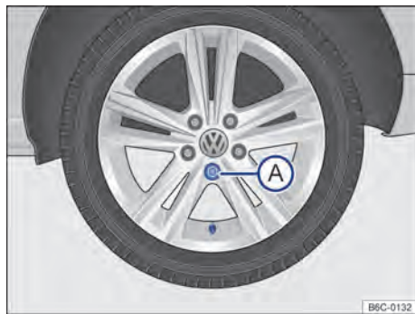
Fig. 223 Troca de roda: sequência de remoção dos parafusos da roda.
