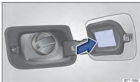
Fig. 215 Na parte interna da portinhola do tanque de combustível: etiqueta com a pressão dos pneus.
