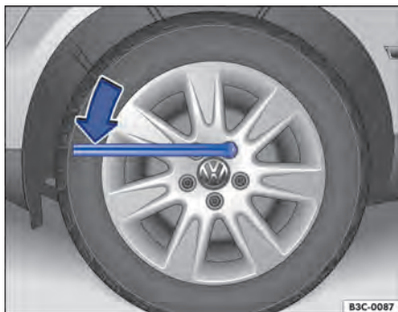
Fig. 220 Troca de roda: soltar os parafusos da roda.
