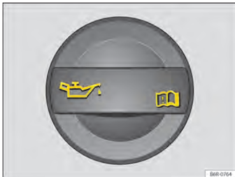
Fig. 207 No compartimento do motor: tampa da abertura para enchimento de óleo do motor.
