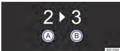
Fig. 90 No instrumento combinado: indicador de troca de marcha.
