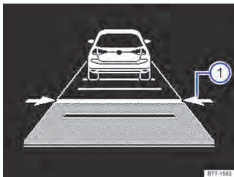
Fig. 111 No display do instrumento combinado: ajustar a distância (representação esquemática, o ACC regula).
