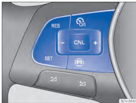
Fig. 105 Lado esquerdo do volante multifunções (variante 1): botões para comandar o limitador de velocidade.
