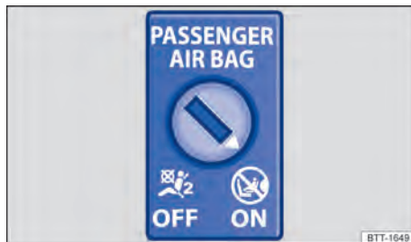
Fig. 38 No painel de instrumentos no lado do passageiro dianteiro: interruptor acionado pela chave para desligar e ligar o airbag frontal do passageiro dianteiro.
