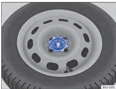
Fig. 217 No compartimento de bagagem: manípulo para fixação da roda de emergência.
