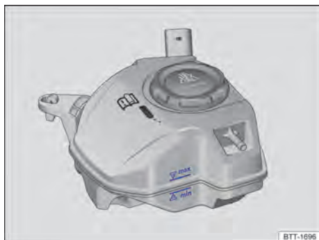
Fig. 208 No compartimento do motor: marcação no reservatório de expansão do líquido de arrefecimento do motor.
