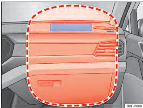
Fig. 37 Local de instalação e área de expansão do airbag frontal do passageiro dianteiro.
