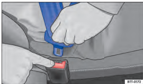
Fig. 31 Soltar a lingueta do cinto de segurança do fecho do cinto de segurança.
