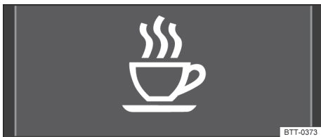
Fig. 18 No display do instrumento combinado: símbolo do sistema de reconhecimento de cansaço.
