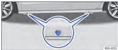
Fig. 221 Pontos de apoio do macaco.
