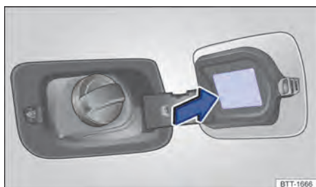
Fig. 215 Na parte interna da portinhola do tanque de combustível: etiqueta com a pressão dos pneus.
