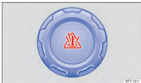
Fig. 209 No compartimento do motor: tampa do reservatório de expansão do líquido de arrefecimento do motor.
