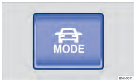
Fig. 100 Na parte superior do console central: botão MODE de seleção do perfil de condução.
