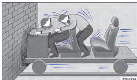
Fig. 26 Um veículo com os ocupantes sem cintos de segurança colide com um muro.
