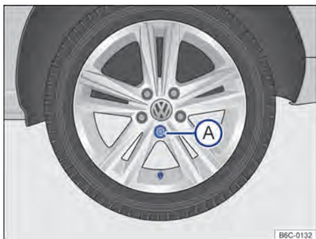
Fig. 219 Retirar a calota integral.
