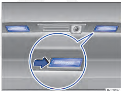
Fig. 301 Na tampa traseira: lanterna da placa de licença.
