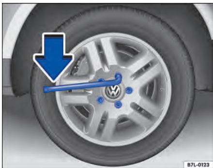
Fig. 282 Troca de roda: soltar os parafusos de roda.
