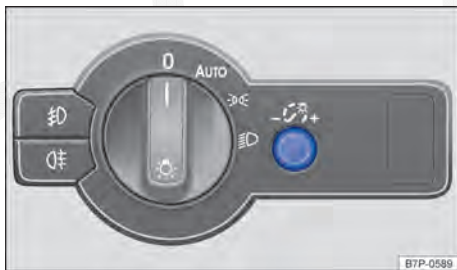
Fig. 109 Ao lado do volante: regulador da regulagem da iluminação dos instrumentos e dos interruptores.
