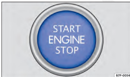
Fig. 165 Sistema de travamento e de partida Keyless Access sem chave: botão de partida.
