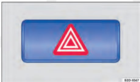
Fig. 270 Na parte superior do console central: botão das luzes de advertência.
