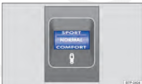
Fig. 178 Na parte inferior do console central: regulador da regulagem da suspensão.
