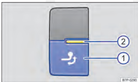
Fig. 143 No compartimento de bagagem à direita: botão de destravamento da rótula de engate.
