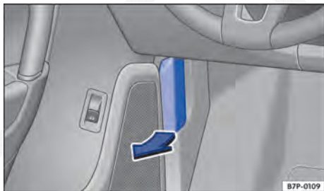
Fig. 249 No área para os pés no lado do condutor: alavanca de destravamento da tampa do compartimento do motor. Em veículos com direção à direita, a disposição dos elementos é espelhada.
