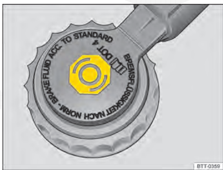
Fig. 173 No compartimento do motor: tampa do reservatório do fluido de freio.
