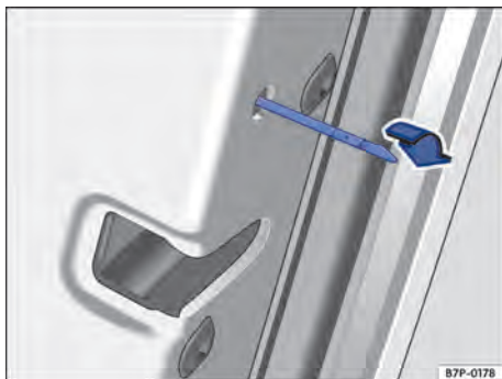
Fig. 274 Travamento de emergência do veículo com a chave de emergência.
