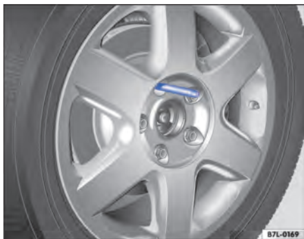
Fig. 288 Troca de roda: pino de montagem no furo superior.
