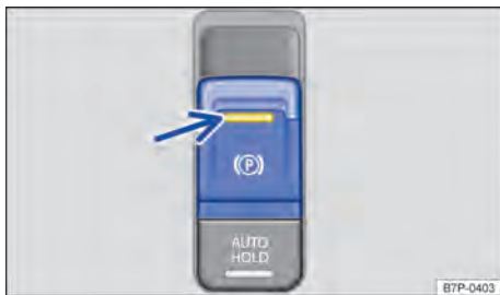
Fig. 171 Na parte inferior do console central: botão do freio de estacionamento eletrônico.
