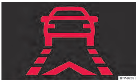
Fig. 214 No display do instrumento combinado: exibição do alerta antecipado.
