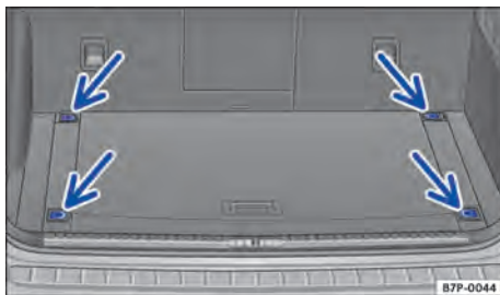
Fig. 130 No compartimento de bagagem: olhais de amarração.
