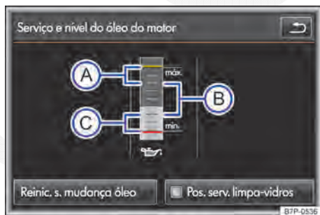
Fig. 251 Sistema Infotainment: indicador do nível do óleo do motor.
