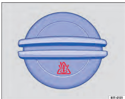
Fig. 255 No compartimento do motor: tampa do reservatório de expansão do líquido de arrefecimento do motor.
