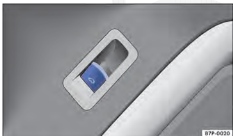
Fig. 50 Na porta do condutor: botão de destravamento da tampa traseira.
