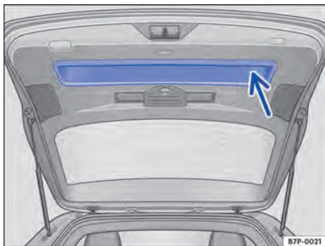
Fig. 52 Tampa traseira aberta: rebaixo para puxar a tampa traseira.
