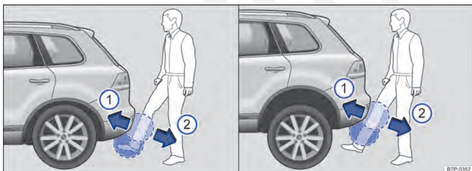
Fig. 45 Sistema de travamento e de partida sem chave Keyless Access: abrir a tampa traseira com abertura comandada por sensor (Easy Open) em diversas alturas do veículo.
