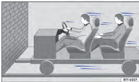
Fig. 84 Um veículo com os ocupantes do veículo sem cinto de segurança está em rota de colisão com um muro.
