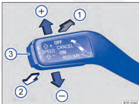
Fig. 208 À esquerda na coluna da direção: alavanca de comando do GRA.
