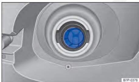
Fig. 239 Com a portinhola do tanque aberta: proteção contra abastecimento errado no bocal de abastecimento do tanque.
