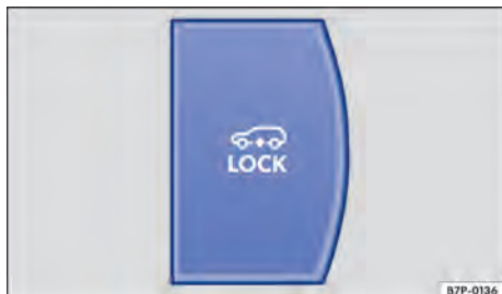
Fig. 177 Na parte inferior do console central: botão Lock do limitador de velocidade.
