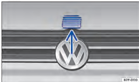
Fig. 250 Alavanca de abertura da tampa do compartimento do motor na grade do radiador.
