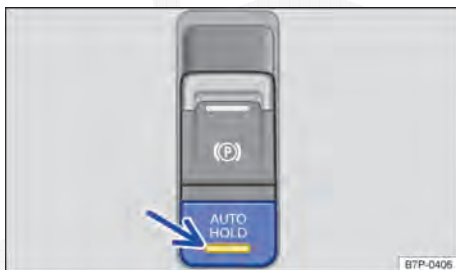
Fig. 189 Na parte inferior do console central: botão do Auto Hold.
