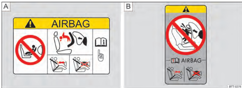
Fig. 102 Representação esquemática: etiqueta do airbag no para-sol [A] ou na coluna B [B].
