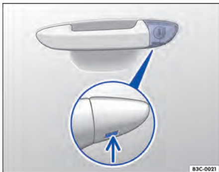
Fig. 272 Maçaneta da porta do condutor: cilindro da fechadura coberto.
