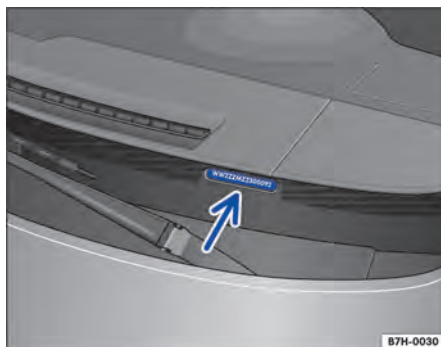
Fig. 31 Na área esquerda do para-brisa: número de identificação do veículo.
