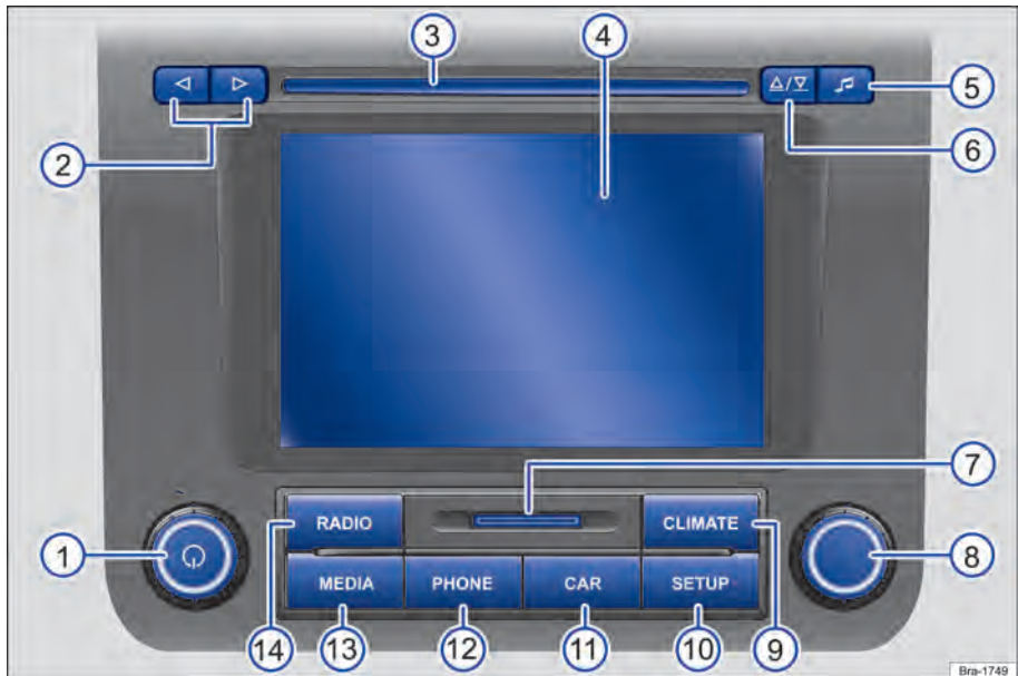
Fig. 21 Vista geral dos comandos do RCD 550.
