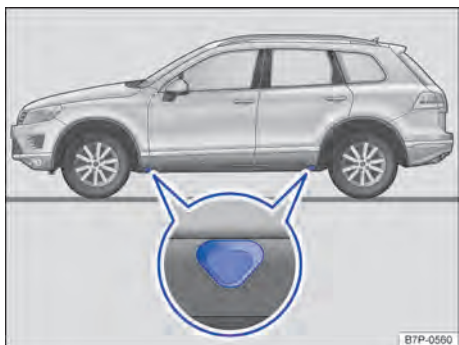
Fig. 284 Pontos de apoio do macaco.
