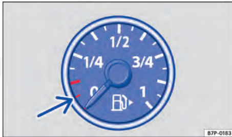
Fig. 236 No instrumento combinado: indicador do nível de combustível para gasolina e óleo diesel.
