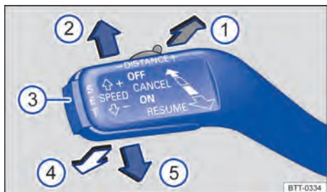
Fig. 212 À esquerda da coluna da direção: alavanca de comando do controle automático de distância.
