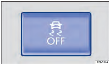
Fig. 172 No console central: botão para ligar e desligar manualmente a função ASR ou do programa eletrônico de estabilidade (ESC).
