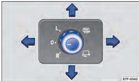
Fig. 123 Na porta do condutor: botão rotativo dos espelhos retrovisores externos.
