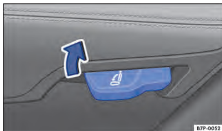
Fig. 66 Área lateral esquerda no banco traseiro: alavanca para ajustar a inclinação do encosto do banco.
