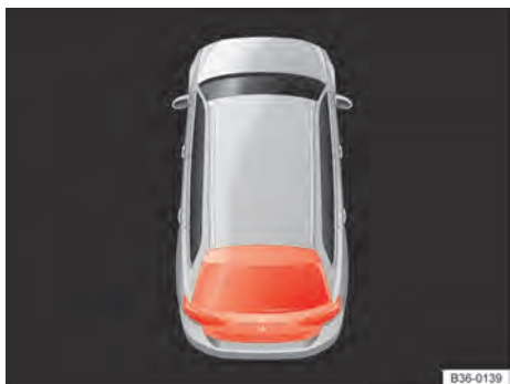
Fig. 49 No display no instrumento combinado: tampa traseira aberta ou fechada incorretamente.
