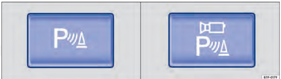
Fig. 195 Na parte superior do console central: variantes do botão para ligar ou desligar o controle de distância de estacionamento. ▶
