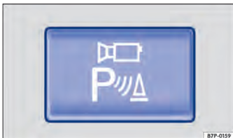
Fig. 205 Na parte superior do console central: botão para ligar manualmente a visão do ambiente.
