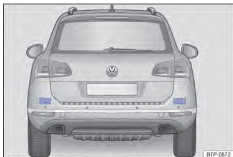
Fig. 221 Vista traseira do veículo: área dos sensores do radar.
