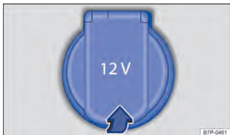
Fig. 160 No porta-objetos no painel de instrumentos: abrir a tomada 12 V.
