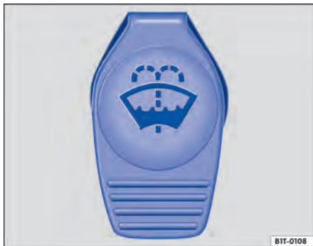
Fig. 120 No compartimento do motor: tampa do reservatório de água dos lavadores dos vidros.
