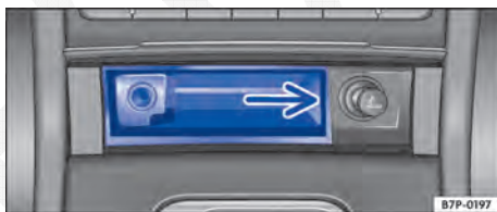
Fig. 156 No console central dianteiro: remover o cinzeiro.
