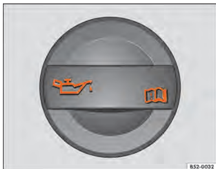
Fig. 252 No compartimento do motor: tampa da abertura para enchimento de óleo do motor.
