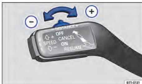
Fig. 213 À esquerda da coluna da direção: ajustar a distância do controle automático de distância.
