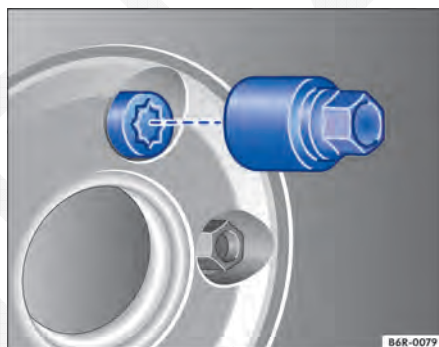
Fig. 283 Troca de roda: Parafusos de roda antifurto e adaptador.
