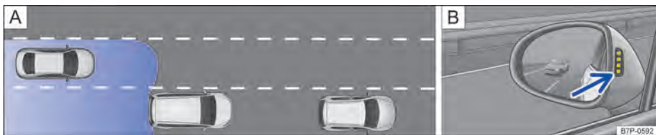
Fig. 222 A) Situação de condução ao ultrapassar com o trânsito traseiro. B) Indicação visual no espelho retrovisor externo esquerdo.
