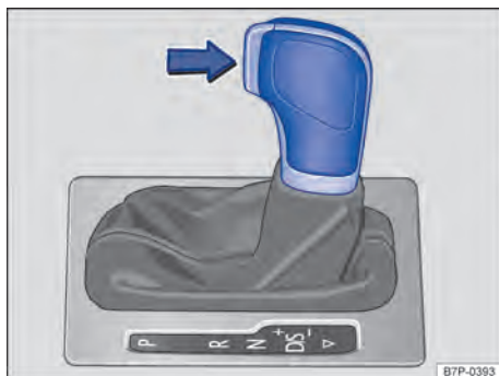
Fig. 167 Alavanca seletora da transmissão automática com botão bloqueador (seta).
