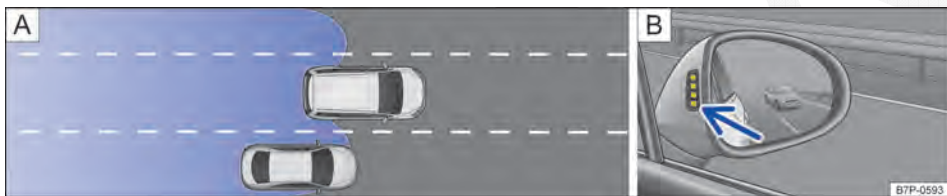
Fig. 223 A) Situação de condução ao ultrapassar e mudar frequentemente de faixa. B) Indicação visual no espelho retrovisor externo direito.
