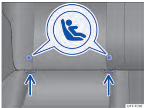
Fig. 104 Representação esquemática: pontos de ancoragem ISOFIX para as cadeiras de criança.
