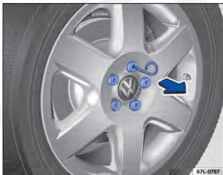
Fig. 280 Remover as capas de cobertura dos parafusos de roda.
