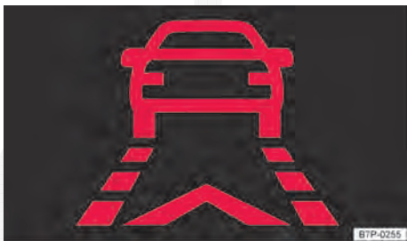
Fig. 216 No display do instrumento combinado: exibição do alerta antecipado.
