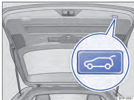
Fig. 54 Na tampa traseira aberta: botão para fechar a tampa traseira.
