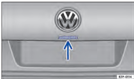
Fig. 53 Na tampa traseira: botão para abrir a tampa traseira.
