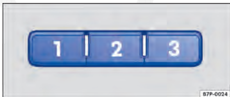
Fig. 58 No revestimento do teto dianteiro: botões do comando de abertura de portão de garagem. ▶
