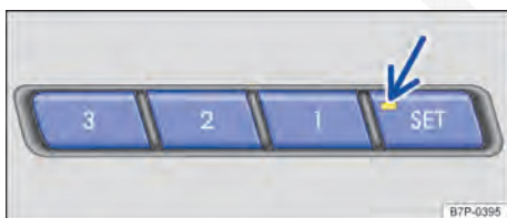
Fig. 80 Na região superior do revestimento da porta do condutor e do passageiro dianteiro: botões de memória dos ajustes do banco.
