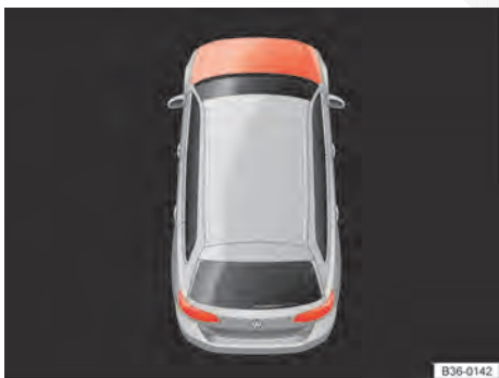
Fig. 248 No display no instrumento combinado: tampa do compartimento do motor fechada incorretamente.
