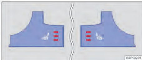
Fig. 78 Na parte traseira do console central: botão do aquecimento dos bancos traseiros.
