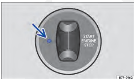
Fig. 277 Cilindro da ignição: destramento de emergência da chave do veículo.
