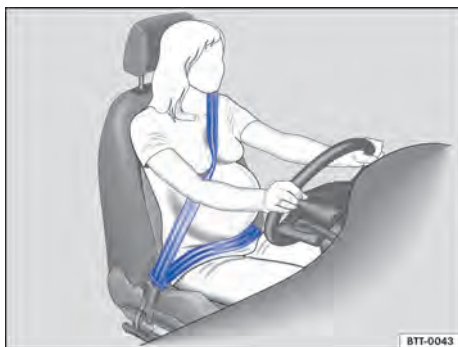
Fig. 92 Posição correta do caderço do cinto de segurança para mulheres grávidas.
