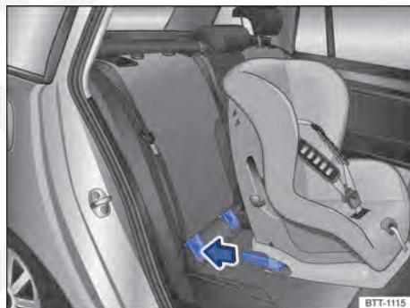
Fig. 105 Representação esquemática: instalar a cadeira de criança ISOFIX com os braços de apoio.
