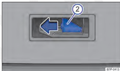
Fig. 276 Por fora do compartimento de bagagem: alavanca de destravamento atrás da cobertura do destravamento de emergência da tampa traseira.
