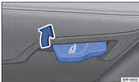
Fig. 124 Parte inferior do banco traseiro: alavanca de destravamento do encosto do banco traseiro esquerdo. Lado direito simetricamente.
