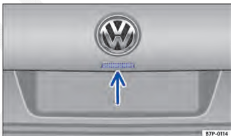
Fig. 51 Na tampa traseira: botão para abrir a tampa traseira.
