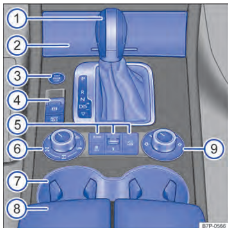
Fig. 9 Vista geral da parte inferior do console central (4MOTION Terrain Tech - veículos com direção à esquerda). Em veículos com direção à direita, a disposição dos elementos é espelhada.
