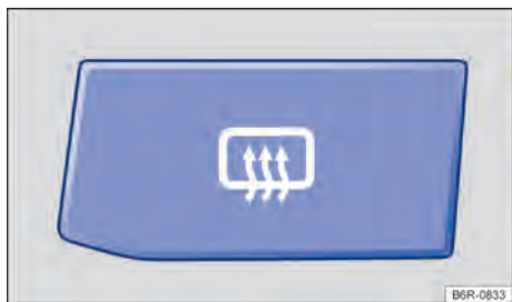
Fig. 77 No console central: botão do desembaçador do vidro traseiro.
