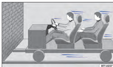
Fig. 23 Um veículo com os ocupantes do veículo sem cintos de segurança está em rota de colisão com um muro.
