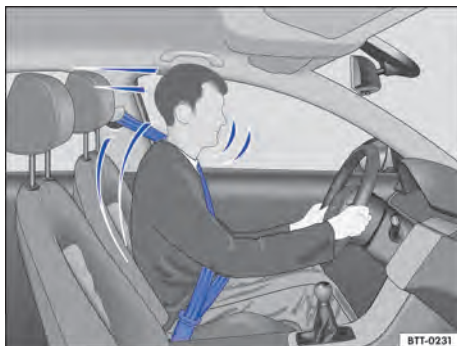
Fig. 27 Condutor protegido pelo cinto de segurança colocado corretamente em uma manobra de frenagem súbita.
