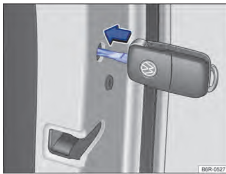
Fig. 55 Travamento de emergência do veículo com a chave do veículo.
