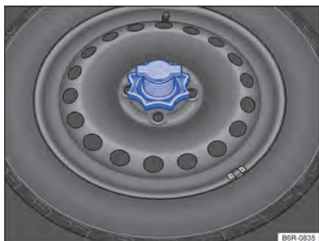
Fig. 136 No compartimento de bagagem: manípulo para fixação da roda de emergência.
