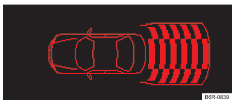
Fig. 83 Exibição do display do controle de distância de estacionamento no rádio.
