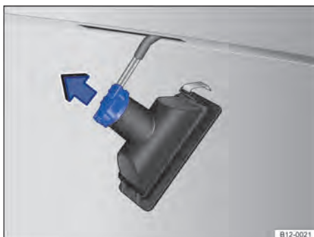
Fig. 112 Lanterna da placa de licença: remover o soquete da lâmpada.
