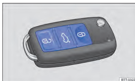
Fig. 49 Botões da chave do veículo com comando remoto. ▶
