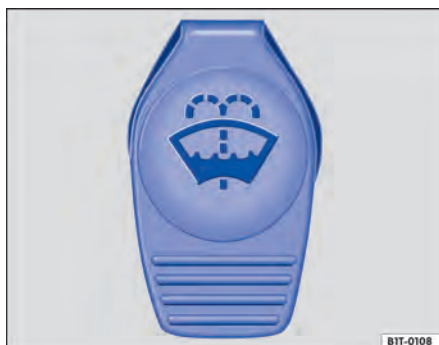
Fig. 124 No compartimento do motor: tampa do reservatório de água dos lavadores dos vidros.
