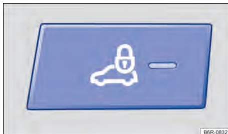
Fig. 47 Luz de controle no painel de instrumentos para indicação do travamento central acionado e/ou indicação do monitoramento do interior do veículo desligado.
