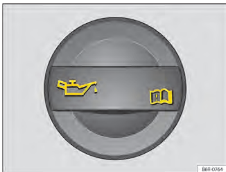
Fig. 126 No compartimento do motor: tampa da abertura para enchimento de óleo do motor.
