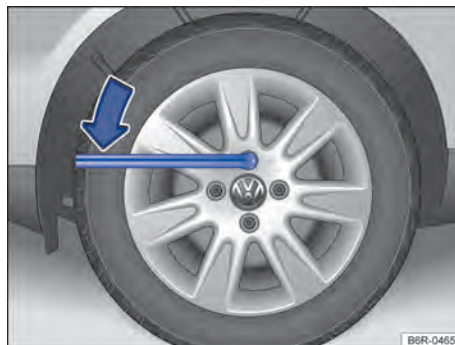
Fig. 141 Troca de roda: soltar os parafusos da roda.
