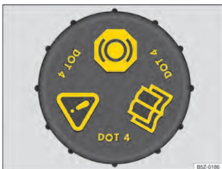
Fig. 130 No compartimento do motor: tampa do reservatório de fluido de freio (variante 2).
