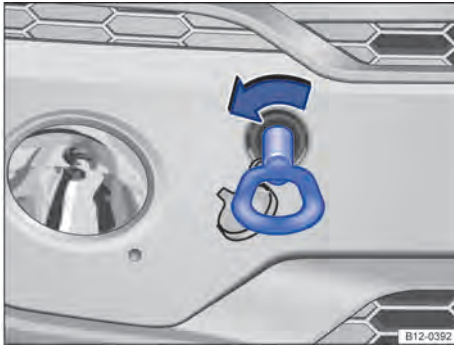
Fig. 121 No para-choque dianteiro à direita: rosquear a argola de reboque.
