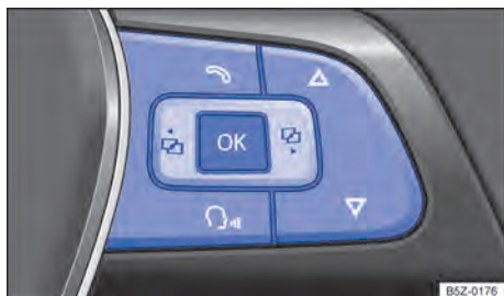
Fig. 19 Lado direito do volante multifunções: teclas de comando dos menus do instrumento combinado.
