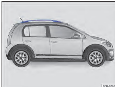
Fig. 99 Suportes longitudinais do bagageiro do teto (ambos os lados).
