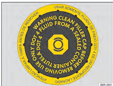
Fig. 129 No compartimento do motor: tampa do reservatório de fluido de freio (variante 1).
