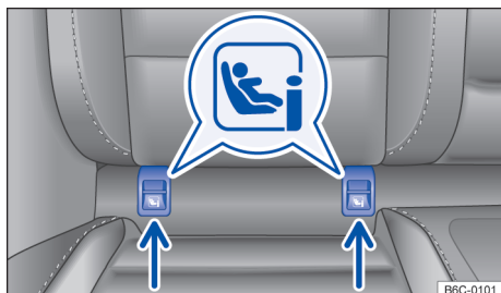
Fig. 45 No banco do veículo: identificação dos pontos de ancoragem inferiores para cadeiras de criança.
