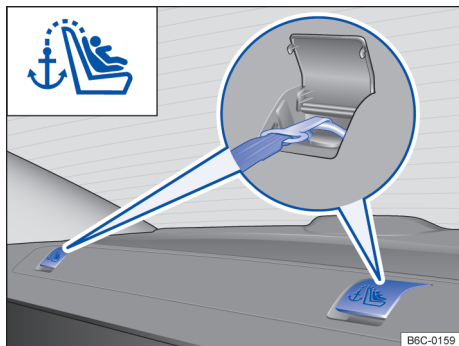
Fig. 46 Olhais de retenção para o cinto de fixação superior na cobertura do compartimento de bagagem.
