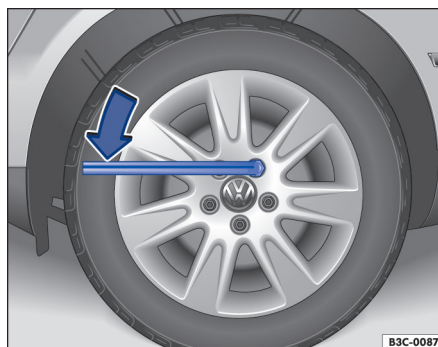
Fig. 164 Troca de roda: soltar os parafusos da roda.
