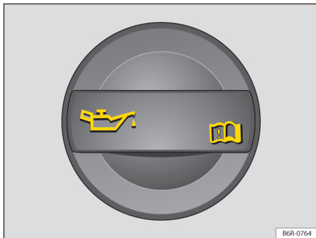
Fig. 150 No compartimento do motor: tampa da abertura para enchimento de óleo do motor.
