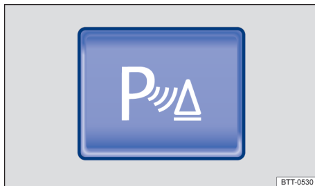
Fig. 102 No console central: botão para ligar e desligar o auxílio de estacionamento (dependendo da versão do veículo).
