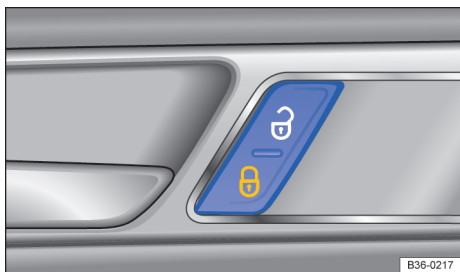
Fig. 56 Na porta do condutor: botão do travamento central.
