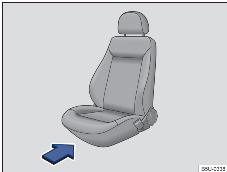
Fig. 51 Na parte frontal do banco do passageiro dianteiro: localização para instalação do suporte do extintor de incêndio.
